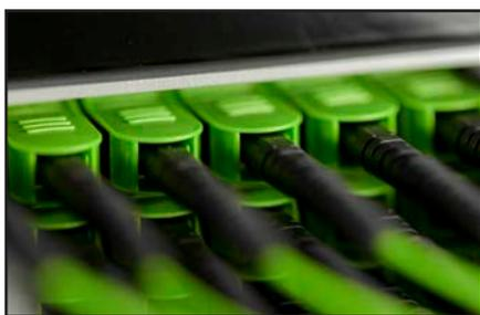
A maioria dos LCs convencionais são desbloqueados através de um clipe no plug. Este mecanismo restringe a densidade de capacidade nos patch panels. Deve ser mantida um espaço entre os plugs ou adaptadores, para que o clipe seja acessível e para habilitar o desbloqueio.
